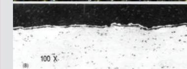
Unas bolas de mala calidad producirán un perfil de tensiones de compresión irregular, deterioro superficial y concentradores de tensiones:
