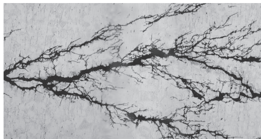
FIGURE 8-2 Rupture en corrosion sous tension d'un acier inoxydable austénitique.
