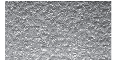
FIGURE 11-4 Texture de surface après simple shot peening
