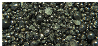
FIGURE 12-3B Billes inacceptables de mauvaise qualité.
