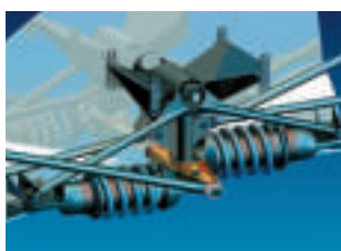
FIGURA 5-2 Montaje de Muelles de Compresión
