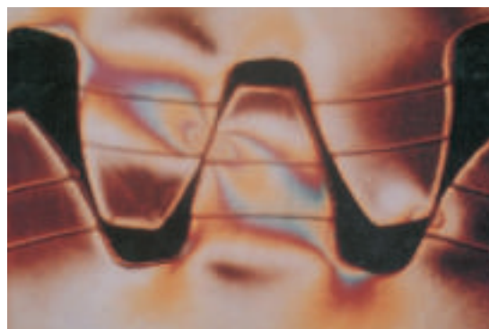
FIGURA 4-3 Imagen Polarizada de las Tensiones Aplicadas
