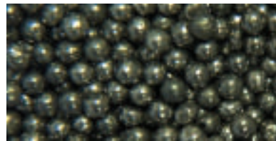
FIGURA 12-3A Bolas de Buena Calidad para el Shot Peening
