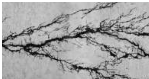
FIGURA 8-2 Rotura por Corrosión Bajo Tensión Sobre un Acero Inoxidable Austenítico
