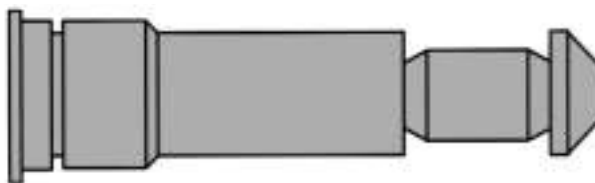
FIGURA 6-1 Esquema de un Eje de Freno
