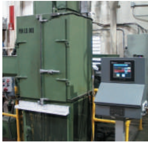
FIGURA 12-10A Máquina Controlada por Ordenador, con Lanza, para Shot Peening de Agujeros
