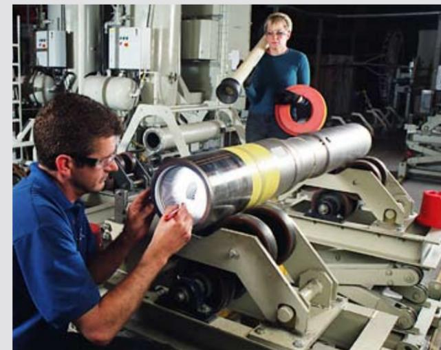
pallinatura delle superfici induce tensioni residue di compressione che possono prolungare la vita di esercizio dei componenti in modo considerevole.
