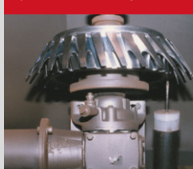
Fig. 4-8 Lance Peening of Fan Disk
